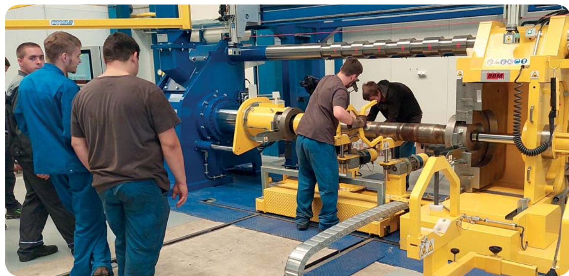
Práce na novém lisu dvojkolí MDT500/1, který je srdcem kolovky.
