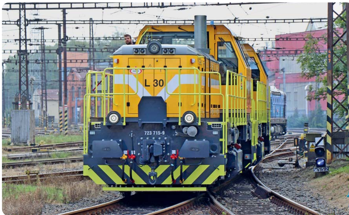
První lokomotivy označené jako 723.710 a 711 převzaly turecké ocelárny Isdemir koncem léta 2019. Jsou vybaveny silnějším spalovacím motorem CAT C27 pro středně těžký posun.
