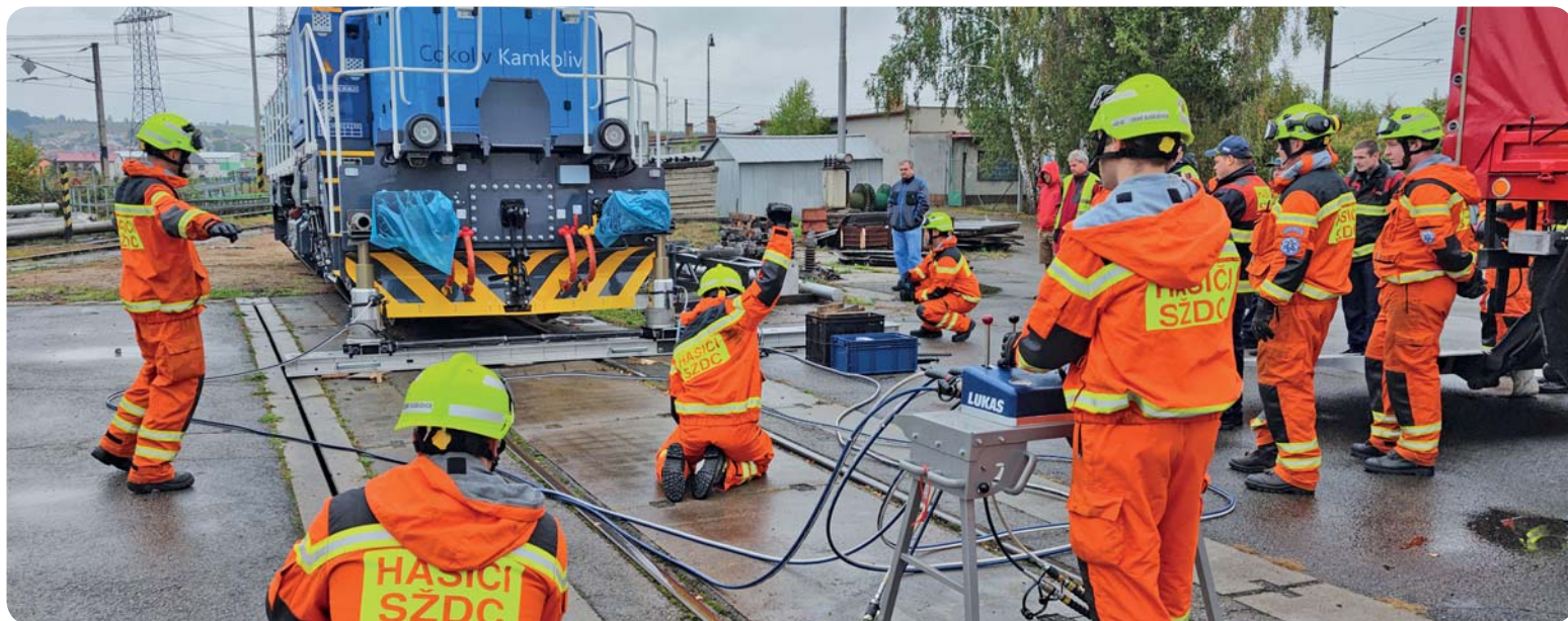
První den. Českobudějovičtí drážní hasiči Správy železnic pomocí hydraulického nakolejovacího zařízení Lukas manipulují s lokomotivou EffiShunter 1000-M. Jejich areál se nachází v kolejovém trianglu mezi strakonickou a tábořskou trať.
