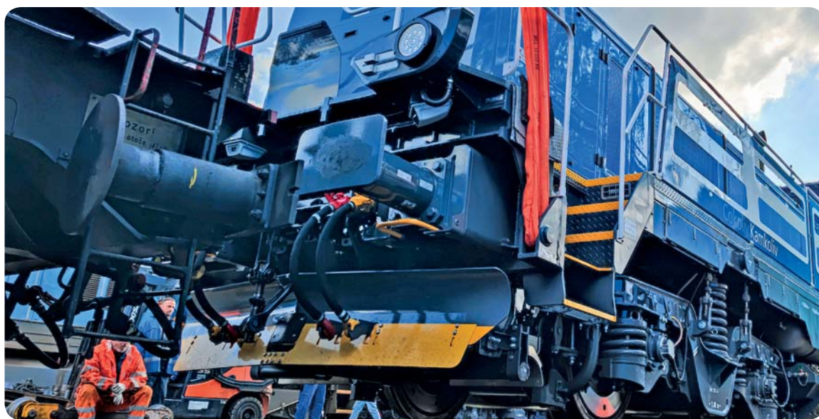
Druhý den. Zvedání EffiShunteru 1000 v areálu ČD Cargo za pomoci kolejového jeřábu. Ten bývá jako součást nehodového vlaku nasazován u nejzávažnějších železničních nehod. (Foto na stránce - Dalibor Palko)
