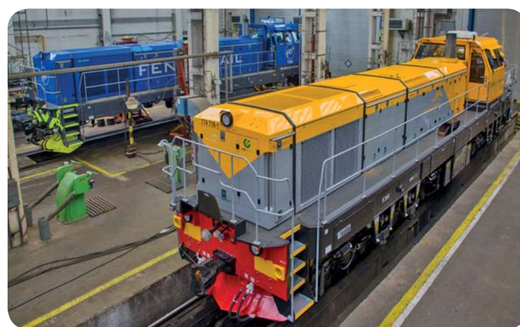
Ukrajinský a finský EffiShunter 1600 během výměny podvozků z normálněrozchodných na širokorozchodné v depu v Hanisce u Košic.
