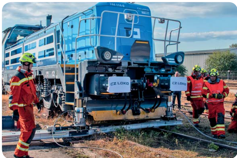
Během cvičení využili drážní hasiči Správy železnic hydraulickou nakolejovací sadu LUKAS.
