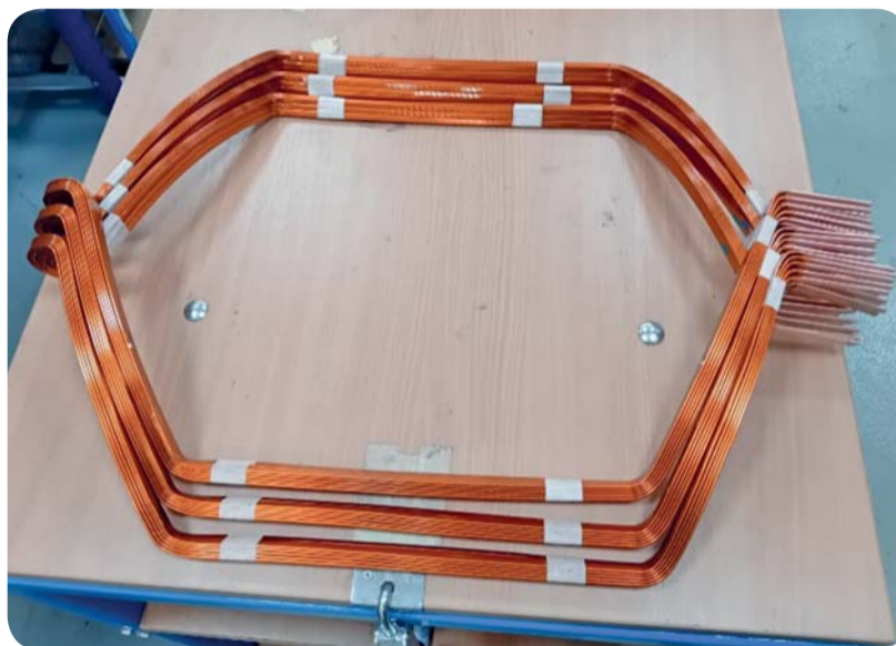
Detailní pohled na precizně natvarované polotovary cívek před obalením a montáží.
