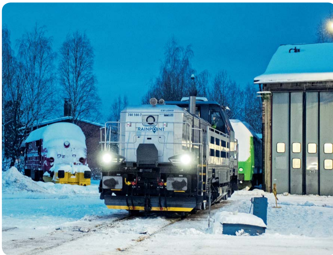
Součástí testování byly i zkoušky nutné pro provoz v zimním režimu až do -40°C s výskytem sněhu, ledu a krup.
