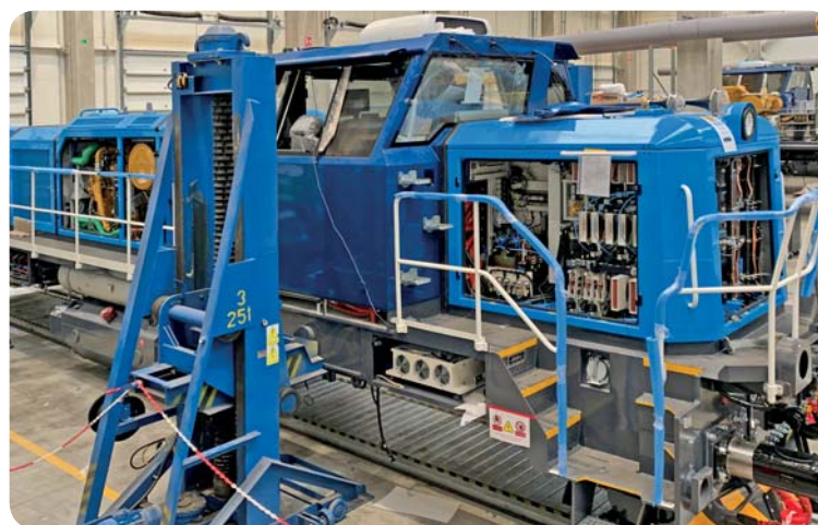
V nové hale běží naplno i výroba lokomotiv EffiShunter 1000M pro ČD Cargo.
