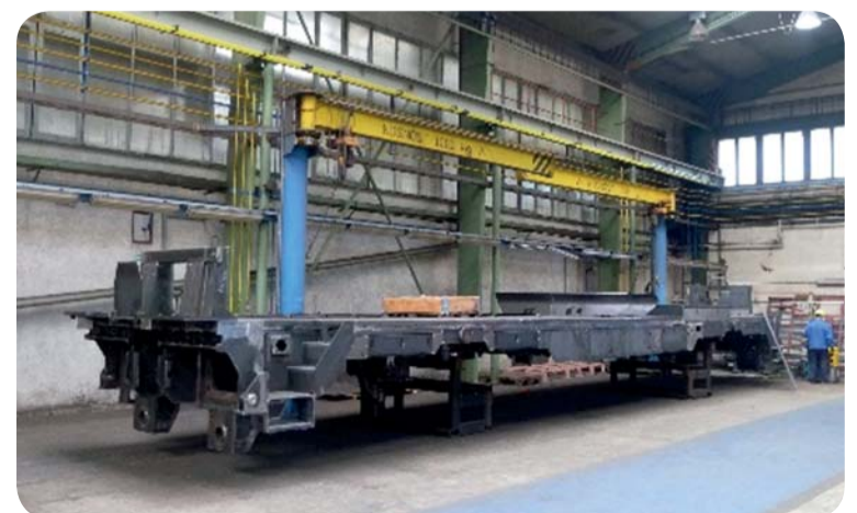
Polotovary svařenců naftové nádrže a hlavního rámu lokomotivy v provozovně Zábřeh.
