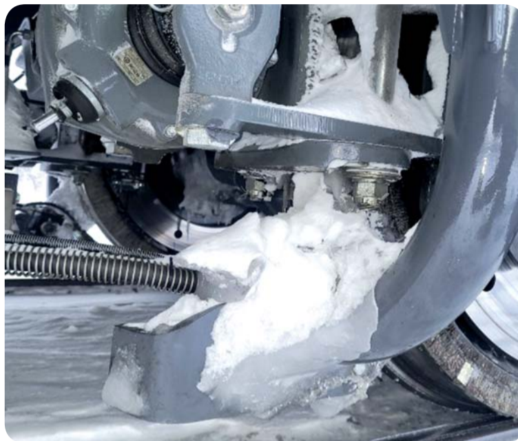
Brzdová jednotka v podvozku obaleném ledem a sněhem.
